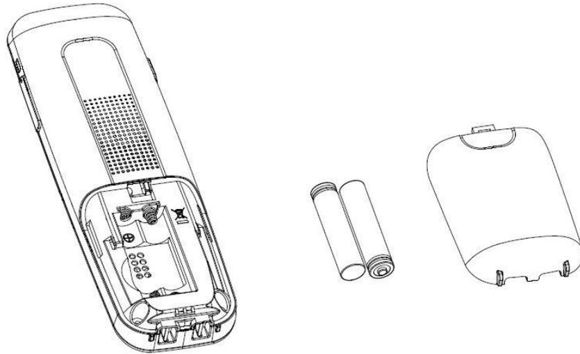
Utilisez uniquement des **batteries rechargeables** NiMH. Note = 400mAH. Type AAA.
